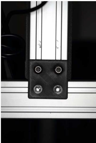
Die Löcher der Platte sollen am Ende auf den Löchern der Nutsteine sitzen. Die Nutsteine können hier mit dem Inbus Schlüssel oder einem kleinen Stock weiter auf Position geschoben werden.
