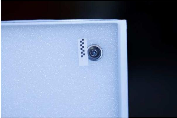
Im Lieferumfang befinden sich ein Maßstab und kleine Nadeln. Den Maßstab mit den Nadeln auf dem Schaumstoff-Schirm oben rechts neben der Schraube innen anbringen.
