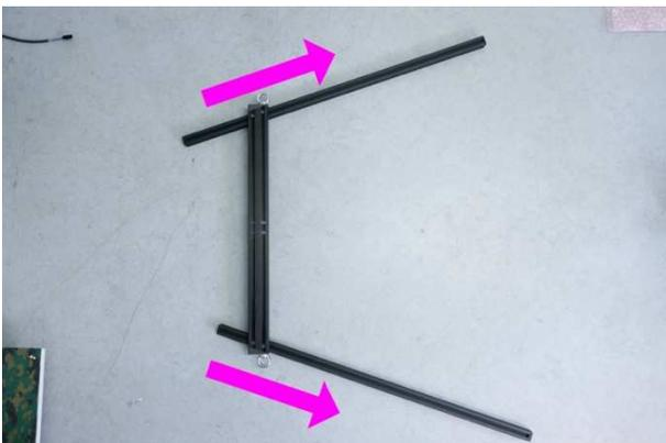
Die beiden Aluprofile in Pfeilrichtung ziehen. Um die Falle im Feld gerade auszurichten, können diese Profile auf gewünschte Position geschoben werden.
