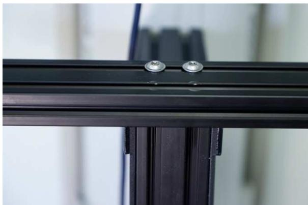
Die Querstrebe auf das obere Ende der Längstrebe auflegen, sodass die Schrauben auf gleicher Position mit den Nutsteinen im Gestell sind. Die Schrauben leicht anziehen.
