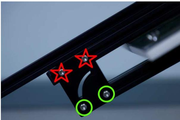
Am Scharnier unter der UV-Lampe befinden sich auf jeder Seite 4 Schrauben. Die grün markierten [Torx 25 Schrauben](#) müssen mit einer Vierteldrehung gelockert werden. Die Schrauben nie herausdrehen. Die Schrauben mit dem roten Stern nicht drehen.
