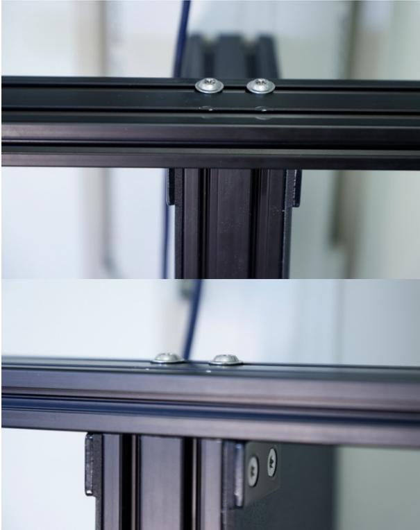
Die Querstrebe nun vorsichtig in Richtung Kameragehäuse schieben, sodass die Aluminiumprofile auf der Seite ohne Schrauben bündig übereinandersitzen.
