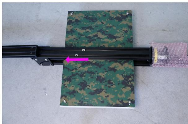
Die beiden Nutg (Helle Objekte im Profil des Aluminiums) in Pfeilrichtung bis ganz zum Ende des Profils bewegen.
