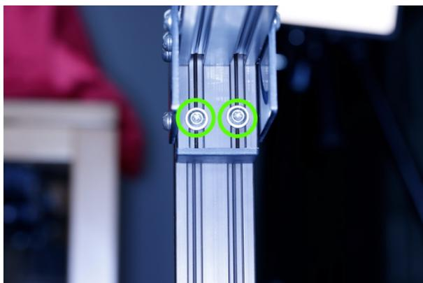
Im Inneren des Scharniers sind 2 [Torx 25](#) Schrauben. Diese fest anziehen.
