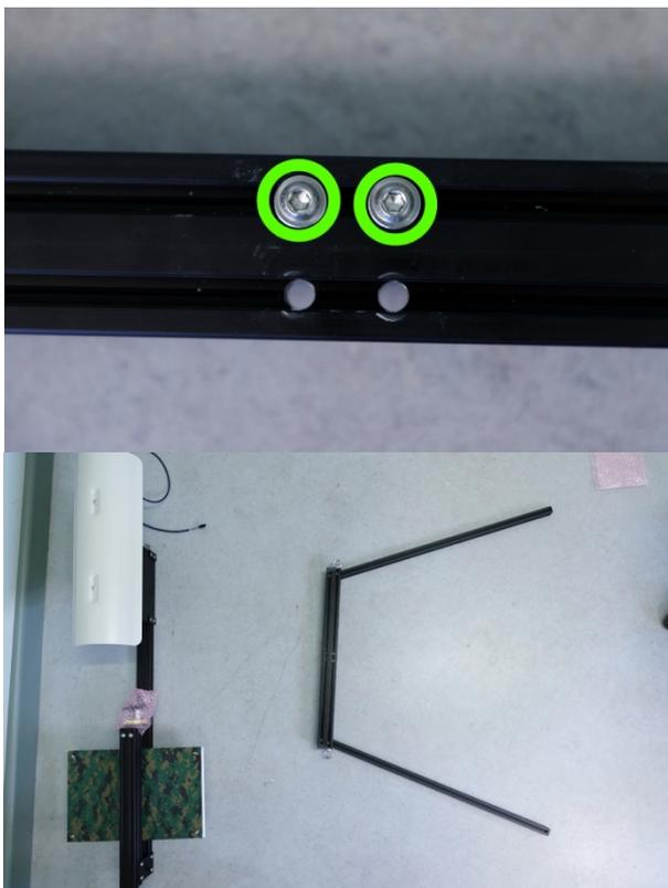
Die Torx 25 Schrauben in die oberen Löcher der Querstrebe stecken. Die Falle liegt dafür wie in [Schritt 7](#): die beiden ausgezogenen Aluprofile berühren den Boden und die mittlere Stange schwebt in der Luft
