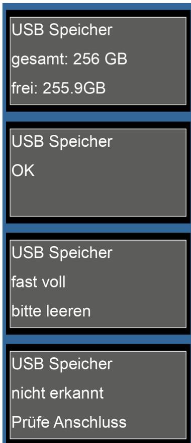
Im Anschluss erfolgt die Abfrage des Speichers, der vor dem Einschalten der Kamera Falle in den USB-Steckplatz eingesteckt wurde. Dabei werden die Werte in Gigabyte (GB) und Prozent angezeigt. Ermittelt werden Kapazität, der belegte Speicher und der noch frei verfügbare Speicherplatz.
