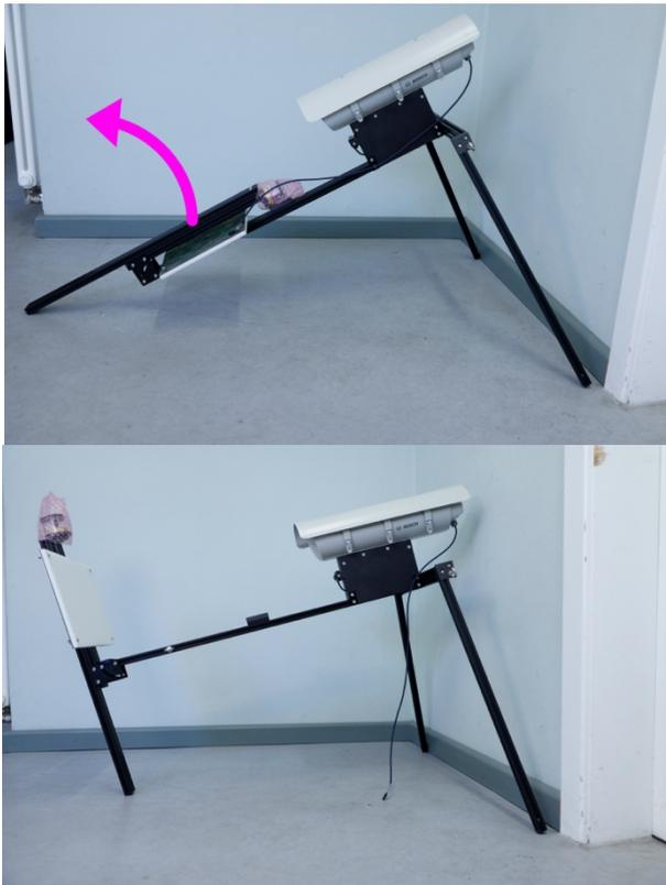
Das Scharnier komplett aufklappen und die Falle aufrichten. Danach die Schrauben aus Schritt 17 wieder mit einer Viertel Drehung (in die andere Richtung) fest anziehen.
