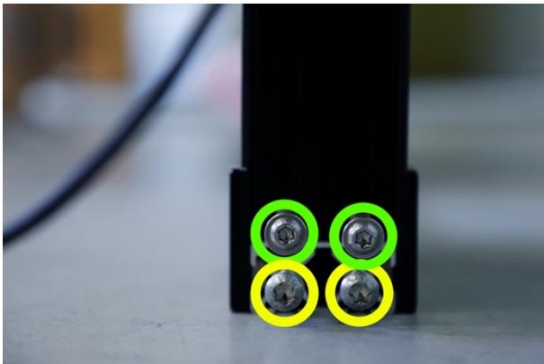
Unter dem Kameragehäuse befinden sich 2x2 Schrauben [Torx 25](#) (grün) und [Torx 30](#) (gelb). Alle Schrauben herausdrehen.
