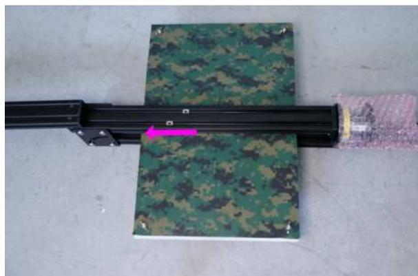
Die beiden Nutsteine (Helle Objekte im Profil des Aluminiums) in Pfeilrichtung bis ganz zum Ende des Profils bewegen.
