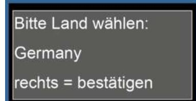
Die Falle fordert zur Eingabe des Landes auf. Mit „**hoch**“ / „**runter**“ kann die Liste an Ländern durchsucht werden, bis das Zielland angezeigt wird. Dann mit „**rechts**“ bestätigen
