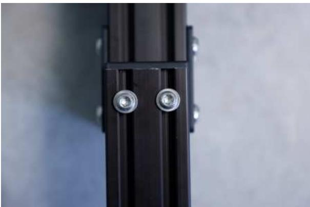
Die beiden separaten [Torx 25 Schrauben](#) in die Löcher einführen und locker in die darunterliegenden Nutsteine schrauben
