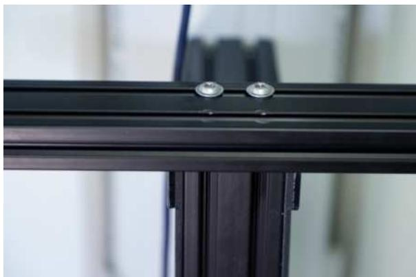
Die Querstrebe auf das obere Ende der Längstrebe auflegen, sodass die Schrauben auf gleicher Position mit den Nutsteinen im Gestell sind.
