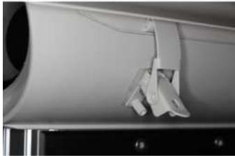
Die Schnappverschlüsse können gelöst werden, indem der Griff vorsichtig nach oben gedrückt wird. Dadurch schnappt der Widerhaken aus einem Gegenlager und kann um dieses herumgeführt werden. Sind alle 3 Verschlüsse gelöst, kann der Deckel nach oben geklappt werden.
