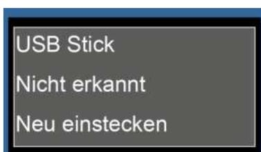
Sollte kein USB-Stick eingesteckt worden sein oder ist dieser fehlerhaft, zeigt die Falle bereits an dieser Stelle den Fehler 3 an. Die Falle startet einen Countdown und startet danach neu. Bitte den Countdown abwarten und die Falle von selbst neustarten lassen. Während des Neustarts bitte den USB Stick erneut einlegen.
