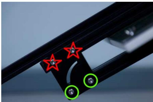
Am Scharnier unter der UV-Lampe befinden sich auf jeder Seite 4 Schrauben. Bitte überprüfen, ob die grün markierten [Torx 25 Schrauben](#) fest angezogen sind.
