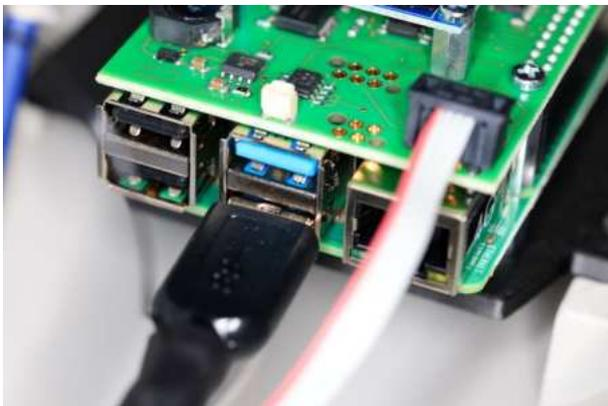
Dann das Kabel am USB-Port unten in der Mitte des Raspberry einstecken.
