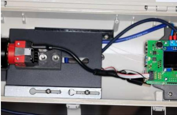
Das neue USB-Y-Kabel zunächst an der Kamera einstecken.
