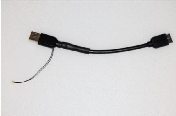
Das neue USB-Y-Kabel ist modifiziert. Es besitzt auf der Seite des USB-A-Steckers einen zusätzlichen, kleinen weißen Anschluss.
