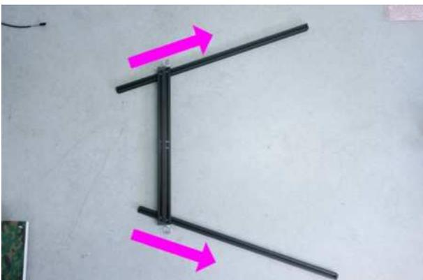
Die beiden Aluprofile in Pfeilrichtung ziehen. Um ARNI im Feld gerade auszurichten, können diese Profile auf gewünschte Position geschoben werden.
