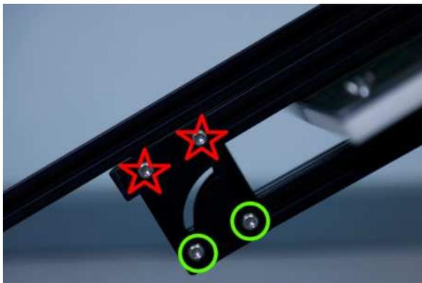
Am Scharnier unter der UV-Lampe befinden sich auf jeder Seite vier Schrauben. Die grün markierten [Torx 25 Schrauben](#) müssen mit einer Vierteldrehung gelockert werden. Die Schrauben nie herausdrehen. Die Schrauben mit dem roten Stern nicht drehen.
