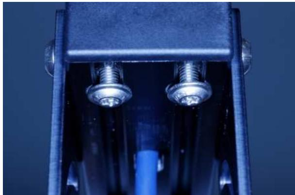
Sollte das Profil etwas klemmen, können an der Unterseite im inneren des Scharniers die beiden Schrauben vorsichtig per Hand etwas gelockert werden. Diese Schrauben nie ganz herausdrehen. Sitzen diese Schrauben zu fest, kann das Scharnier gelockert und umgeklappt werden (Schritt 17 und 18), und die Schrauben mit einem Torx 25 gelockert werden.
