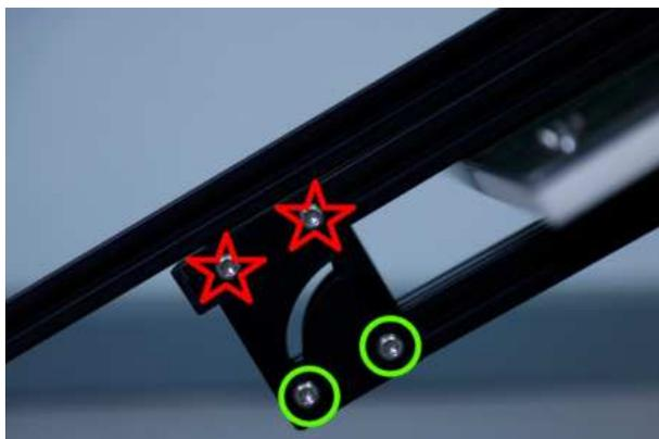
Am Scharnier unter der UV-Lampe befinden sich auf jeder Seite vier Schrauben. Bitte überprüfen, ob die grün markierten [Torx 25 Schrauben](#) fest angezogen sind.
