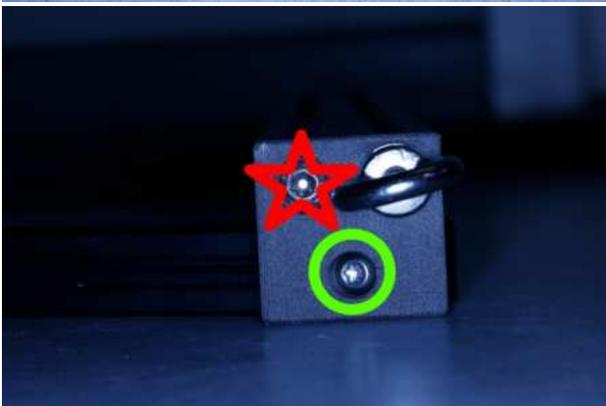
Danach die grün markierte [Torx 25](#) Schraube mit ca. einer halben Umdrehung lockern, bis das Bein beweglich ist, aber noch nicht locker sitzt.
