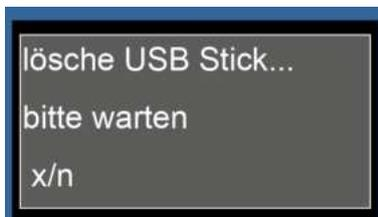
Wenn die Frage mit „ja“ bestätigt wird (durch Drücken der **hoch** Taste), löscht ARNI alle vorherigen Aufnahme Läufe. Je nach Größe des Speichers kann dies einen Moment dauern. ARNI zeigt den Fortschritt an mit x = Anzahl der bereits gelöschten Ordner und n = Anzahl aller zu löschenden Ordner.
