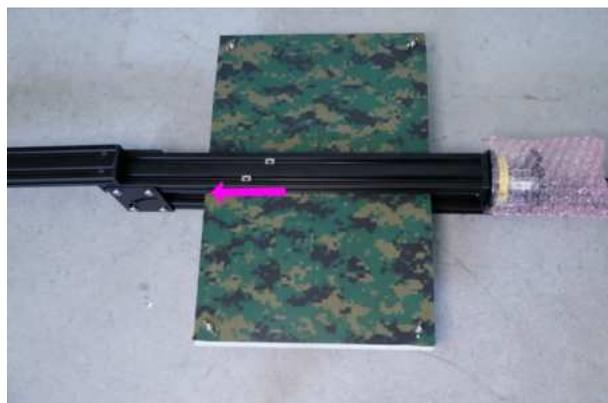
Die beiden Nutsteine (Helle Objekte im Profil des Aluminiums) in Pfeilrichtung bis ganz zum Ende des Profils bewegen. Entfällt bei Geräten, die von K2W Lights vertrieben werden.
