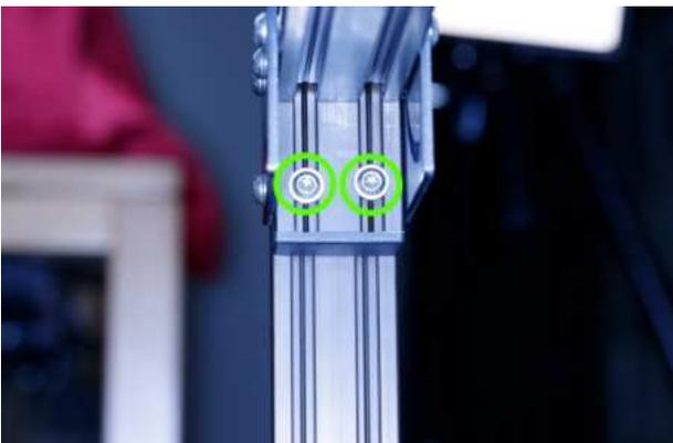
Im Inneren des Scharniers sind zwei [Torx 25](#) Schrauben. Diese fest anziehen.
