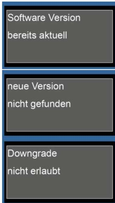
Wenn ARNI bereits die aktuelle Software besitzt, fährt sie mit dem Update nicht fort. Auch führt eine fehlende Versionskennzeichnung oder eine ältere Version zum Abbruch des Updates. ARNI kann in diesem Fall weiter betrieben und [eingestellt](#) werden.
