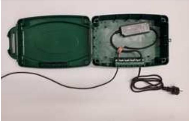
Für den Netzbetrieb sollte ein Netzteil mit 60 W verwendet werden. Wir empfehlen 12V / 5 A. Das Netzteil sollte zusätzlich mit einer Spritzwassergeschützten (IP54) Kabelbox gegen Witterung geschützt werden. Ein Verlängerungskabel mit Schutzkontakt-Stecker kann verwendet werden, um das Netzteil zu verlängern. Die Box bietet genug Stauraum, um den Schutzkontakt-Stecker gegen Spritzwasser zu schützen.
