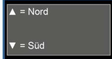
ARNI fragt zunächst die Nord /Süd Ausrichtung ab: Durch die **Hoch Taste** wird die Nordhalbkugel ausgewählt und die **runter Taste** steht für die Südhalbkugel. Durch die **hoch Taste** wird die östliche Hemisphäre ausgewählt und die **runter Taste** steht für die westliche Hemisphäre.
