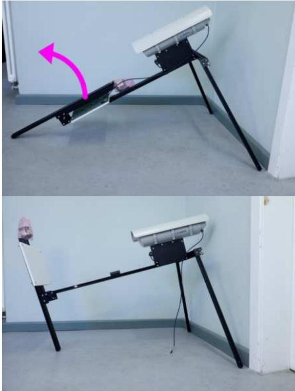
Das Scharnier komplett aufklappen und ARNI aufrichten. Danach die Schrauben aus Schritt 17 wieder mit einer Viertel-drehung (in die andere Richtung) fest anziehen.
