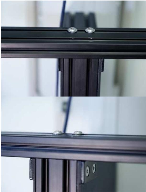
Die Querstrebe nun vorsichtig in Richtung Kameragehäuse schieben, sodass die Aluminiumprofile auf der Seite ohne Schrauben bündig übereinandersitzen.
