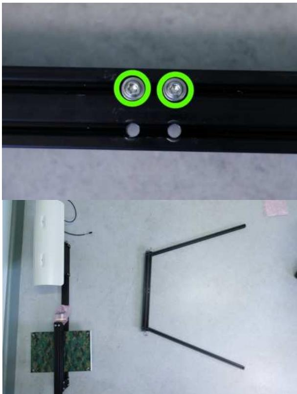
Die Torx 25 Schrauben in die oberen Löcher der Querstrebe stecken. ARNI liegt dafür wie in [Schritt 7](#): die beiden ausgezogenen Aluprofile berühren den Boden und die mittlere Stange schwebt in der Luft
